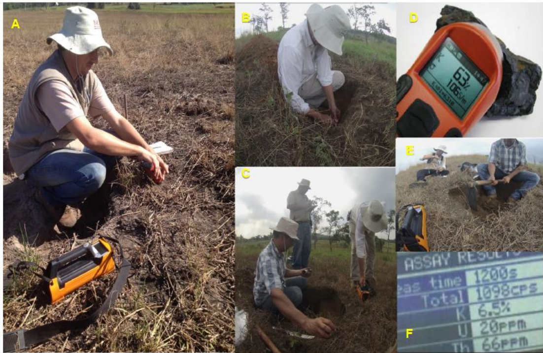
Figura 2. (A) Pesquisador realizando leitura do topo do solo com sensor KT-10 S/C enquanto o sensor RS-230 BGO está funcionando; (B) Mensurando em sub-superfície com o sensor KT-10 S/C (B); (C) Preparando trincheira de até 20 cm de profundidade para coleta das amostras para laboratório, enquanto está sendo preparado o sensor RS-230 BGO; (D, F) Exemplo dos painéis dos sensores com leituras realizadas pelo KT-10 S/C e RS-230 BGO (respectivamente); (E) Abertura de trincheira e coleta de amostra de laboratório, também pode ser visto o equipamento RS-230 BGO em funcionamento.
